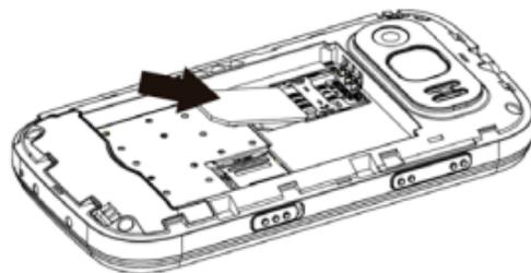
4. Die Batterie wie in der folgenden Abbildung gezeigt einsetzen. Sicherstellen, dass der Rand mit den Kontakten zur SOS-Taste zeigt.
